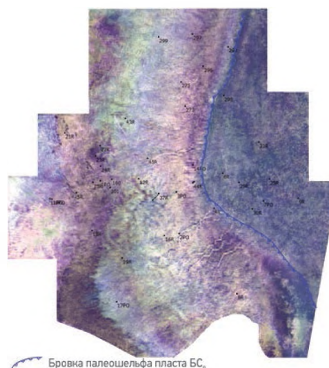
Рис. 3. Срез кубов спектральной декомпозиции (частоты 18, 27, 33 Гц) RGB в интервале ачимовской толщи циклита БС 8-9
