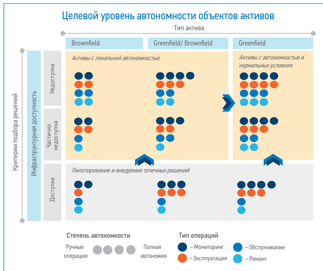
Рис. 4. Степень автономности элемента актива (А.Ю. Зацепин) Fig. 4. The degree of autonomy of an asset element (Artem Yu. Zatsepin)
