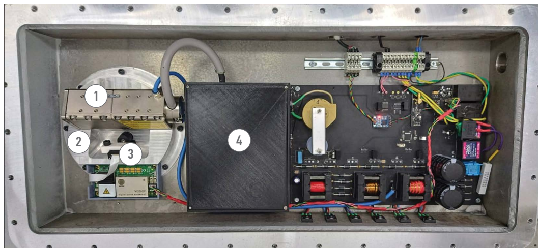
Рис. 1. Компоновка элементов модуля анализа шлама. Составлено авторами Fig. 1. Layout of module elements. Figure prepared by the authors
