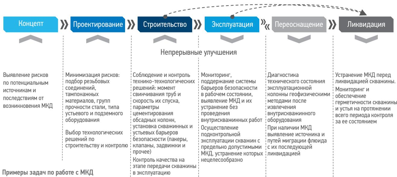
Рис. 1. Подходы к работе с МКД на различных этапах жизненного цикла скважины [1]
