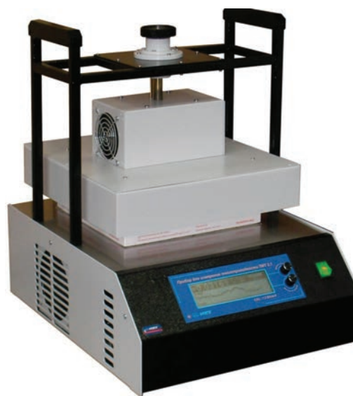
Рис. 6. Прибор для определения коэффициентов теплопроводности. Составлено авторами
