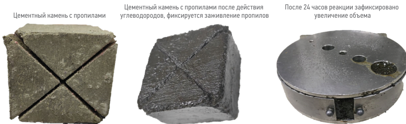
Рис. 3. Качественное тестирование на самовосстановление. Составлено авторами Fig. 3. Qualitative self-healing testing. Prepared by the authors
