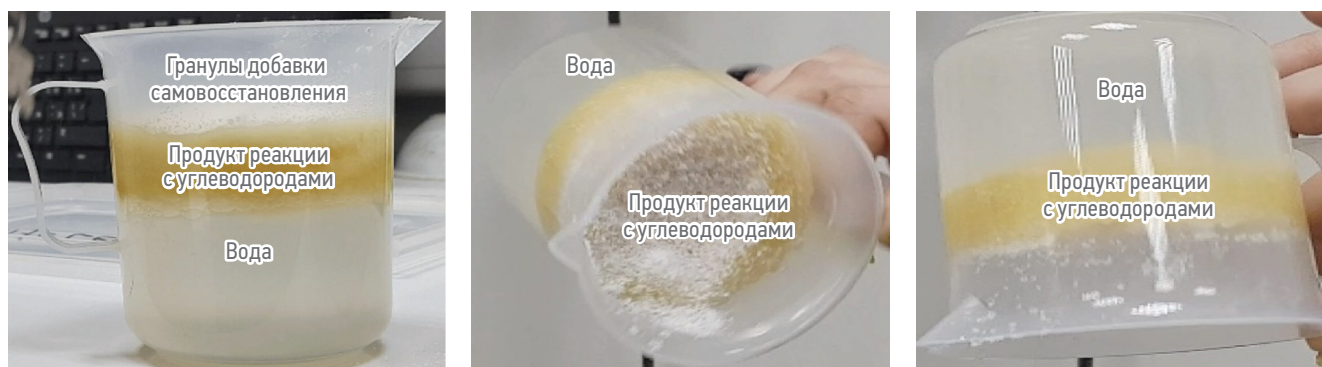
Рис. 1. Реакция добавки для самовосстановления с углеводородной жидкостью. Продукт реакции настолько прочный и адгезионно активный, что при переворачивании сосуда вода, которая находится под углеводородной жидкостью, не стекает вниз. Составлено авторами
