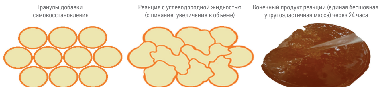
Рис. 2. Механизм и стадии реакции добавки самовосстановления с углеводородной жидкостью. Составлено авторами
