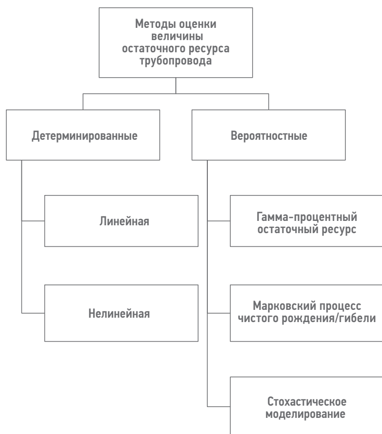
Рис. 1. Классификация методов оценки остаточного ресурса трубопровода. Составлено авторами Fig. 1. Classification of pipeline remaining life assessment methods. Compiled by the authors
