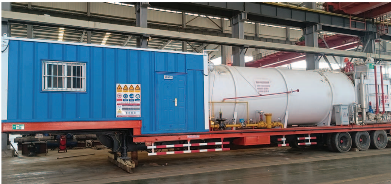
Рис. 1. Генератор воды в сверхкритическом состоянии [8] Fig. 1. A generator for producing of supercritical water [8]
