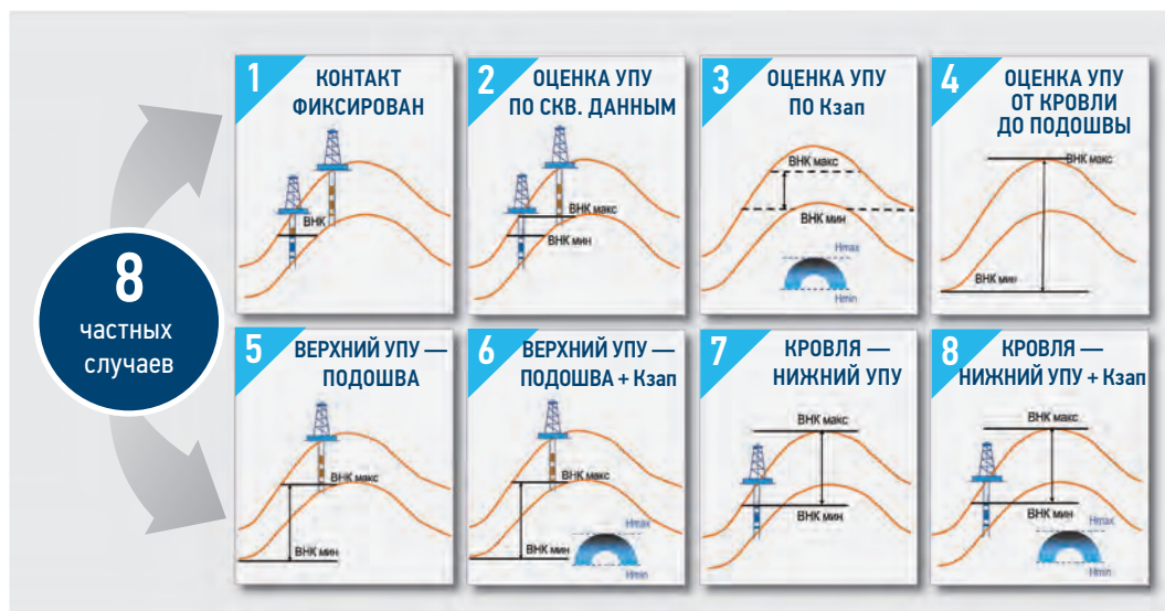
Рис. 3. Частные случаи при 2D МВР продуктивного объема (неопределённость оценки УПУ). Составлено автором Fig. 3. Possible scenarios for net pay volume predication included in the workflow (fluid contact uncertainty). Prepared by the author
