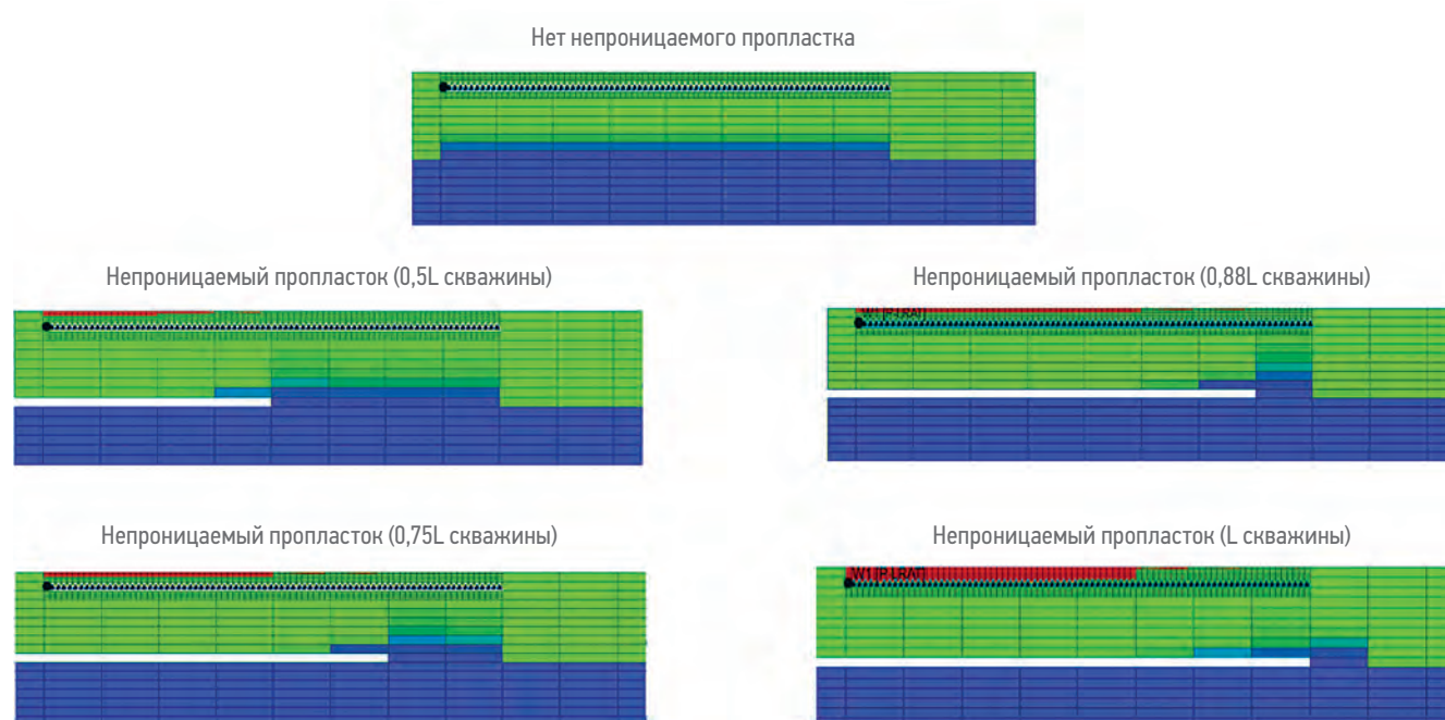
Рис. 11. Варианты распространения непроницаемого пропластка. Составлено авторами Fig. 11. Configuration impermeable barriers. Compiled by the authors
