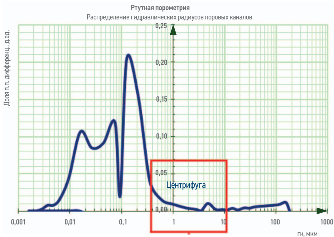
Рис. 10. Распределение радиусов поровых каналов, выделяемых разными методами. Составлено авторами Fig. 10. Distribution of pore channel radius obtained by different methods. Prepared by the authors
