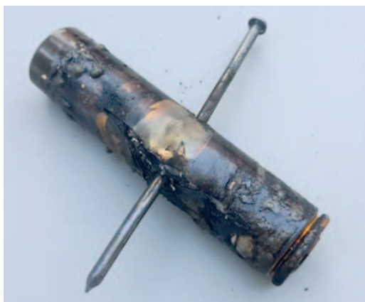
Рис. 1. Образец из \text{LiFePO}_4 после воздействия. Предоставлено автором Fig. 1. The sample of \text{LiFePO}_4 sell after the impact. Prepared by the author
