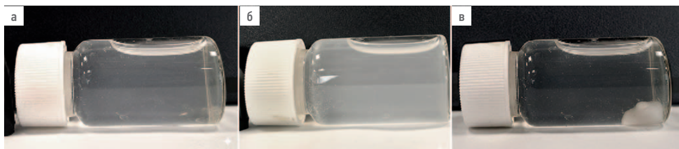
Рис. 7. Внешний вид продуктов деструкции полимера при воздействии соляной кислоты (5%) через 1 минуту (а), 60 минут (б) и 24 часа (в). Составлено авторами Fig. 7. Appearance of polymer degradation products under the influence of hydrochloric acid (5%) after 1 minute (а), 60 minutes (б), and 24 hours (в). Prepared by the authors
