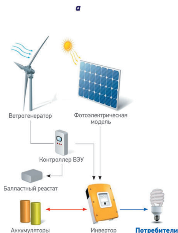
Рис. 1. Условная схема (а) и внешний вид (б) ветро-солнечной электростанции (ВЭУ – ветроэнергетическая установка)
