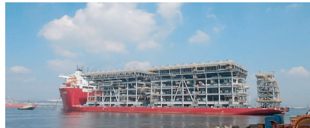
Рис. 2. Транспортировка модулей для проекта Gorgon LNG
