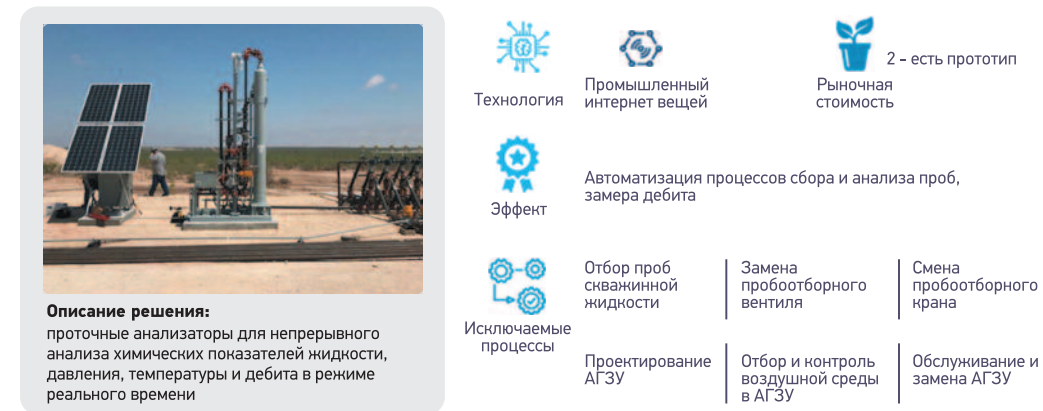
Рис. 4. Сценарий применения устьевых анализаторов вместо АГЗУ для снижения трудозатрат
