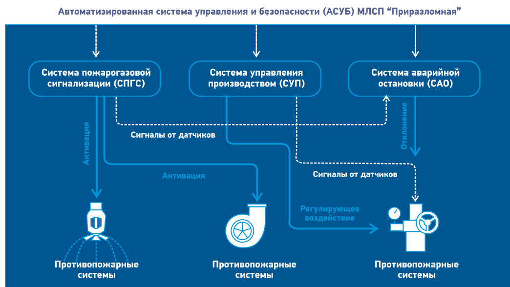
Рис. 1. Принцип работы автоматизированной системы управления и безопасности МЛСП «Приразломная»
