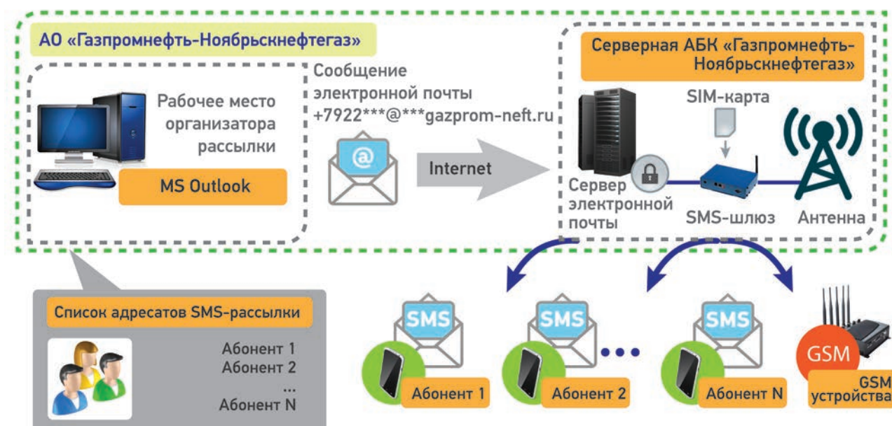
Рис. 3. Структурная схема системы SMS-информирования, разработанная в АО «Газпромнефть-Ноябрьскнефтегаз»
