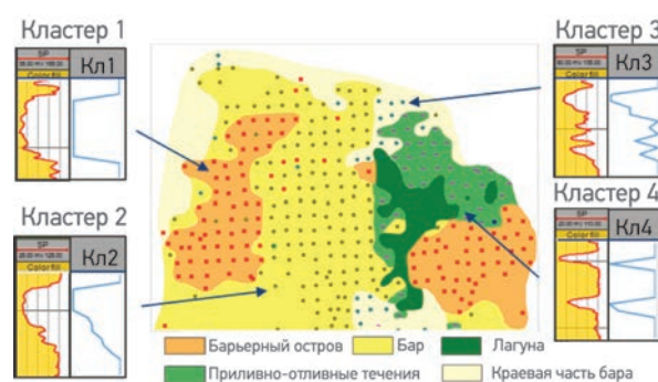
Рис. 2. Пример применения кластерного анализа при определении фациальных зон пласта Ю 1 одного из месторождений
