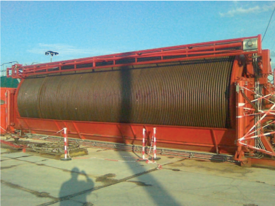
Рис. 4. Установка с нестандартно расположенным барабаном с гибкой трубой диаметром 2 3/8" длиной 9000 м
