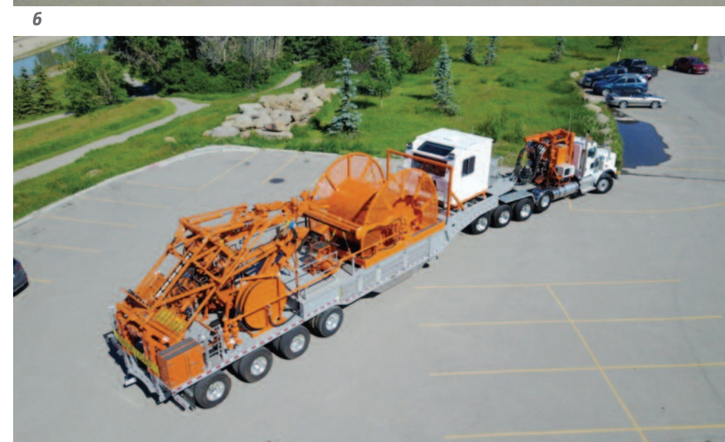
Рис. 2. Установка ГНКТ повышенной грузоподъемности (NOV) 2 7/8": а – вид сбоку; б – вид сверху
