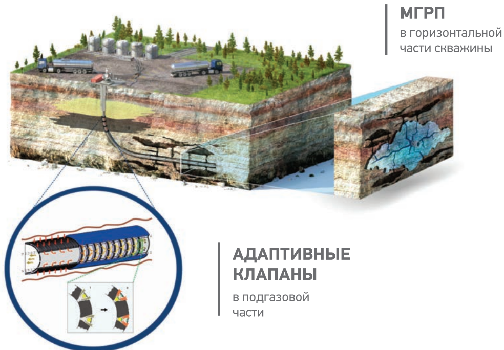
Рис. 3. Принципиальная схема комплексной системы заканчивания скважины
