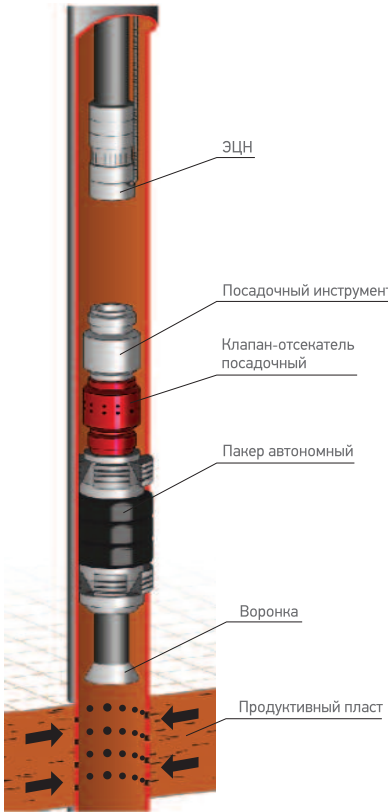
Рис. 1. Схема клапана-отсекателя 1ПРОК-КЗП производства ООО НПФ «Октябрьский пакер»
