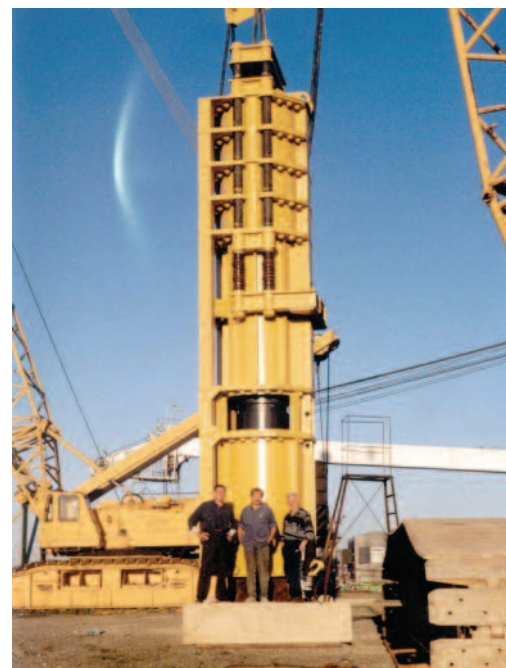
Рис. 5. Электромагнитный молот МЭМ-400 на испытаниях ПО «Черноморнефтегаз», 1992 г.
