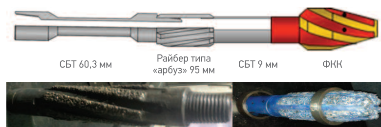
Рис. 3. Оборудование для проработки ствола скважины (СБТ – стальная буровая труба; ФКК – фрезер колонный конусный)
