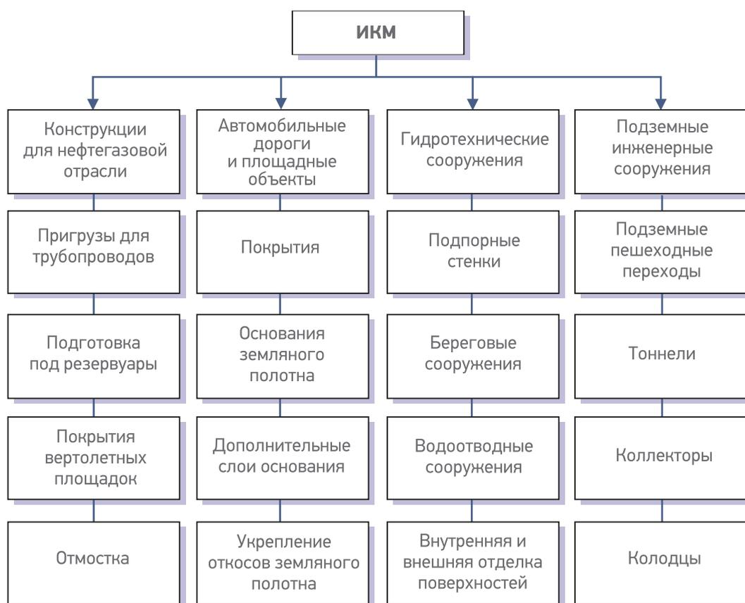
Рис. 3. Область применения ИКМ на основе укрепленных цементом местных грунтов
