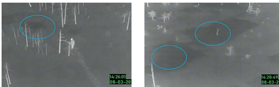
Рис. 5. Пример обнаруженных зон аномальной температуры снежного покрова, ассоциированных с зонами подтаивания болот, на правом рисунке специалист проводит проверку аномалии методом прямого наблюдения [1] Fig. 5. An example of the detected zones of anomalous temperature of the snow cover associated with the zones of thawing swamps, in the right figure, the specialist checks the anomaly by direct observation [1]
