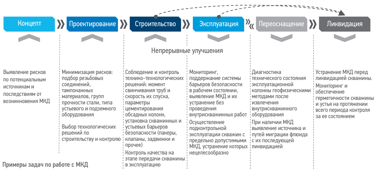
Рис. 5. Подходы к работе с МКД на различных этапах жизненного цикла скважины. Составлено авторами Fig. 5. Sustained casing pressure regulation approaches at various stages of the well life cycle. Prepared by the authors
