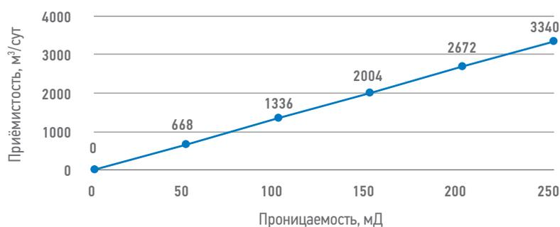
Рис. 2. Расчётная приёмистость скважины № IR2-141. Составлено автором
