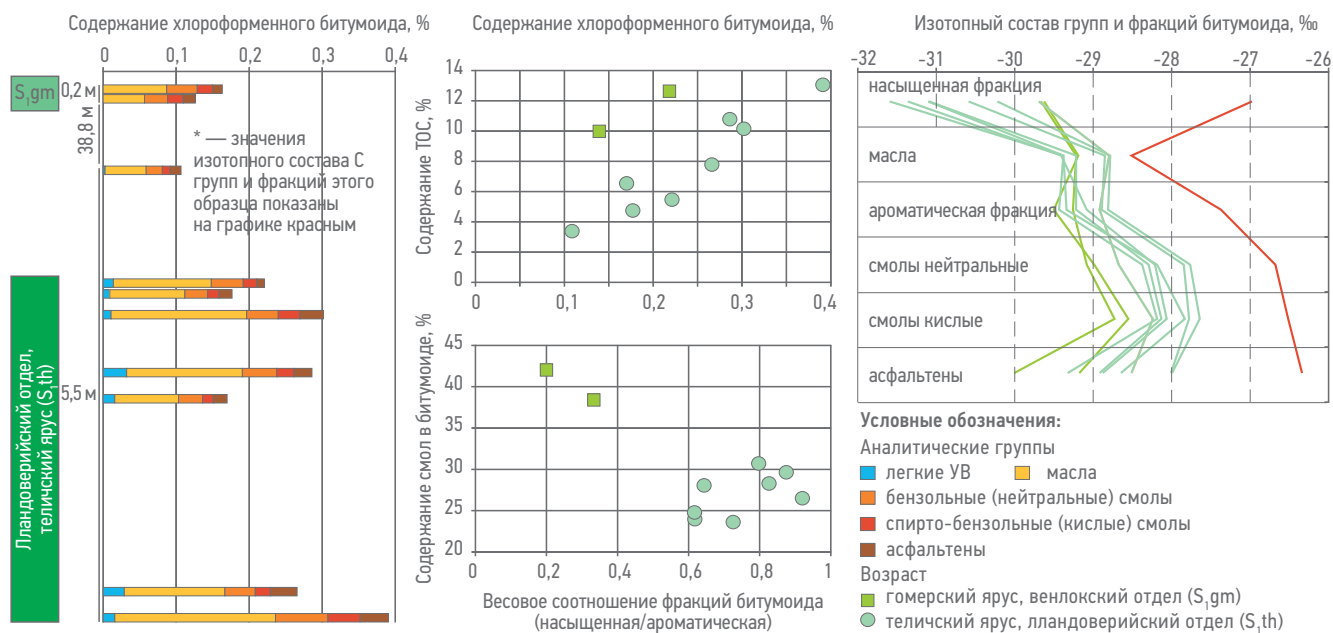
Рис. 5. Битуминологическая и изотопная характеристика образцов граптолитовых сланцев скважины на Лескинском ЛУ. Составлено авторами Fig. 5. Bituminological and isotopic characteristics of graptolite shales from well on Leskinsky license area. Prepared by the authors
