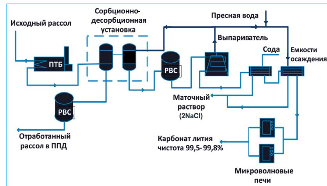
Рис. 1. Технологическая схема установки извлечения лития: ПТБ – печь трубчатая блочная, РВС – резервуар вертикальный стальной
