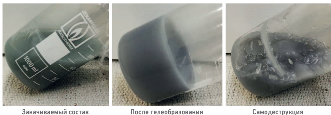
Рис. 3. Деструкция вязкоупругого геля с течением времени. Составлено авторами Fig. 3. Destruction of a viscoelastic gel as a function of time. Prepared by the authors
