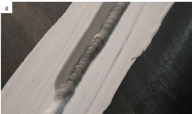
Рис. 4. Контроль герметичности стального резервуара при помощи керосино-меловой пробы. а — выявление несплошности в околошовной зоне в виде сквозной трещины; б — общий вид проведения контроля внутри резервуара (П.С. Шлапак)
