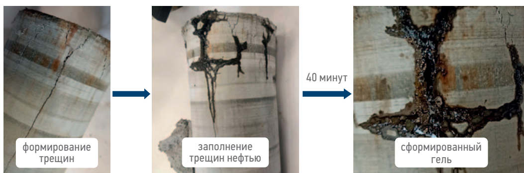
Рис. 8. Процесс формирования герметизирующего геля при контакте СВЦ с углеводородом. Составлено авторами
