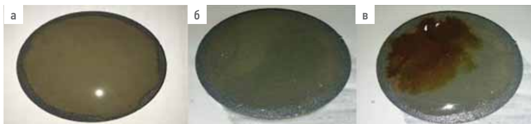
Рис. 1. Вид исходной фильтрационной корки бурового раствора (а), после выдержки в брейкерном составе (б) и после тестирования на остатки полисахаридной составляющей (в) (АО «ТомскНИПИнефть»)
