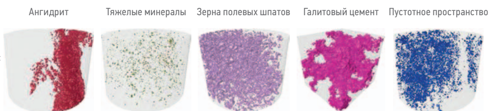
Рис. 1. Распределение компонентов, составляющих породы пласта В13 (по материалам работ, выполненных на керне Чонского проекта «Газпромнефть-ГЕО» сотрудниками геологического факультета МГУ им. М.В. Ломоносова Д.В. Корост, С.Р. Корост, С.Р. Гафуровой)
