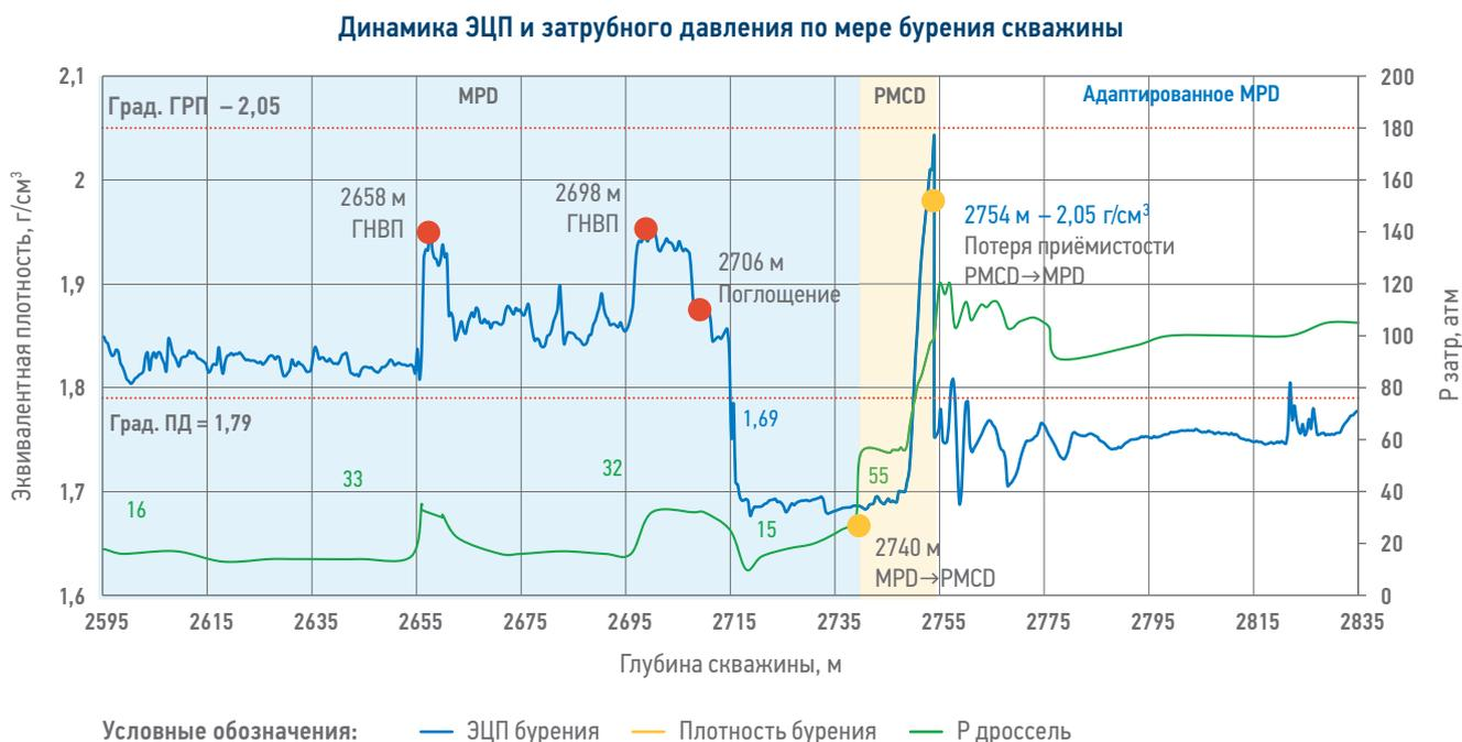
Рис. 6. Изменение параметров бурения с DPM по мере углубления скважины (Д.С. Криволапов)
