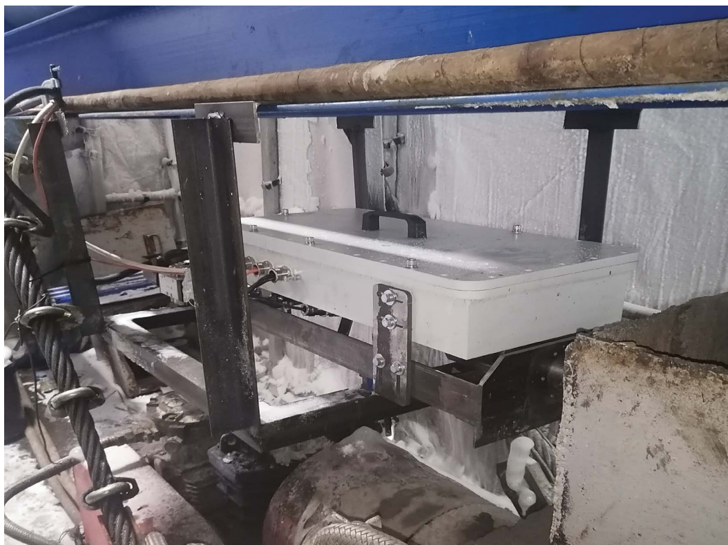
Рис. 5. Опытно-промышленный образец модуля анализа шлама, смонтированный на буровой установке. Составлено авторами
