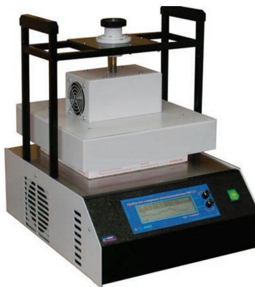
Рис. 6. Прибор для определения коэффициентов теплопроводности. Составлено авторами Fig. 6. Device for determining thermal conductivity coefficients. Prepared by the authors
