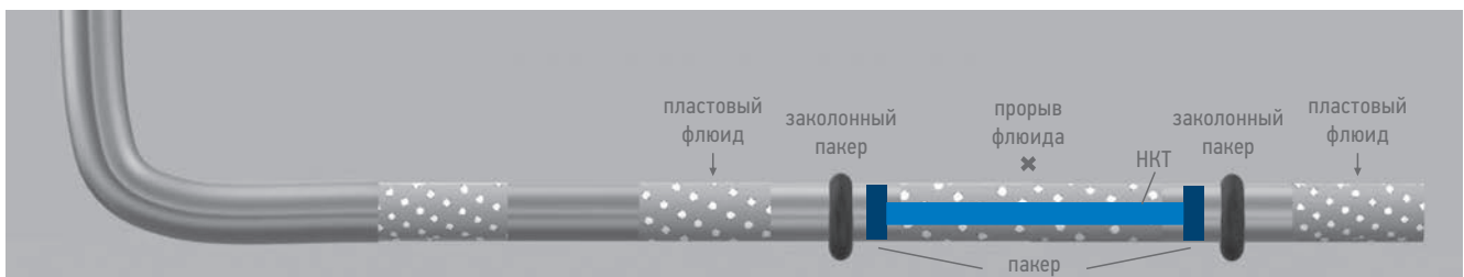
Рис. 1. Схема установки двухпакерной системы. Составлено авторами Fig. 1. Installation diagram of the straddle system. Prepared by the authors
