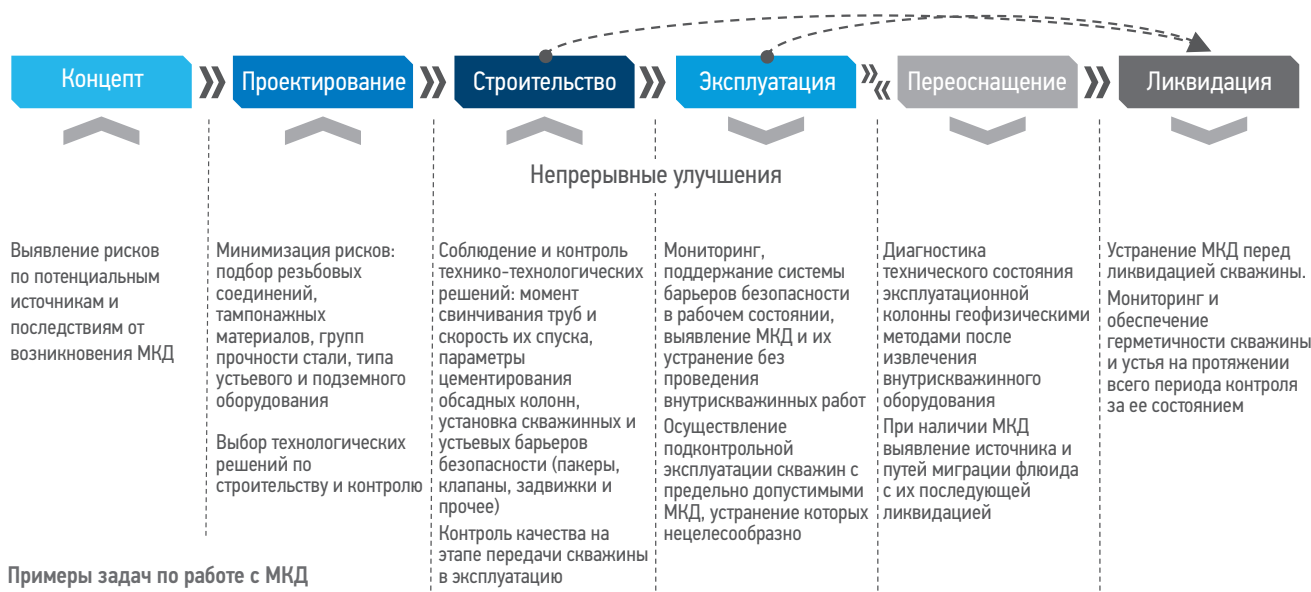
Рис. 1. Подходы к работе с МКД на различных этапах жизненного цикла скважины [1] Fig. 1. Sustained casing pressure regulation approaches at various stages of the well life cycle [1]
