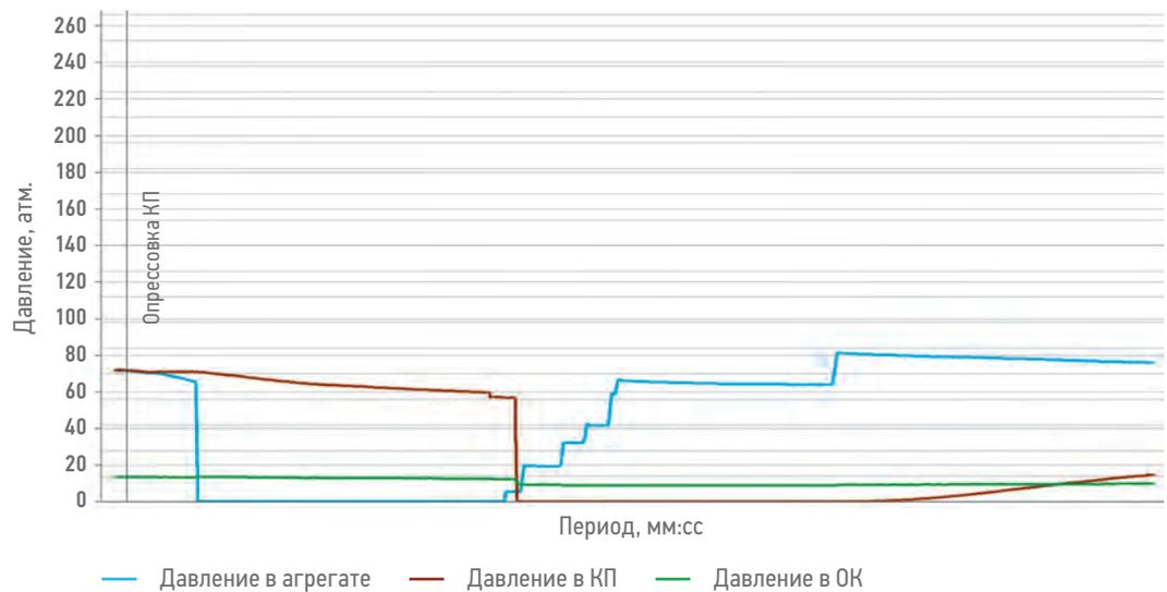
**Рис. 4.** Опрессовка цементного камня воздухом после реакции СВЦ с углеводородом. Составлено авторами
