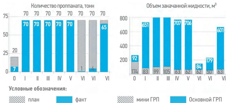
Рис. 10. Сравнение объемов закачки при различных стадиях ГРП.
