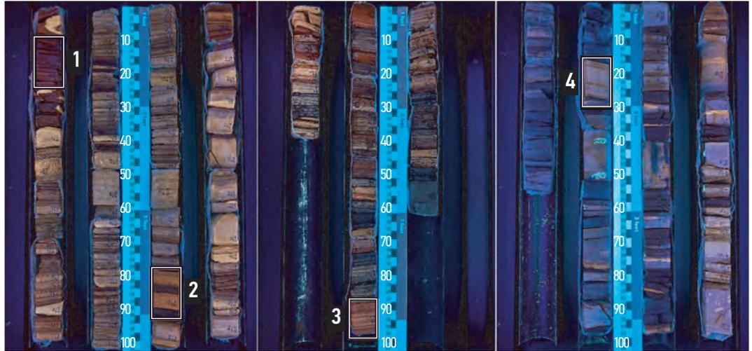
**Рис. 4.** Фотографии ретрокерн в ультрафиолетовом свете. Результаты пиролиза (обр. 1 —  $S_0 + S_1 = 4,05$ ;  $S_2 = 53,8$ ;  $TOC = 8,29\%$ ; обр. 2 —  $S_0 + S_1 = 4,85$ ;  $S_2 = 62,07$ ;  $TOC = 8,13\%$ ; обр. 3 —  $S_0 + S_1 = 0,66$ ;  $S_2 = 48,59$ ;  $TOC = 5,93\%$ ; обр. 4 —  $S_0 + S_1 = 2,06$ ;  $S_2 = 18,33$ ;  $TOC = 3,05\%$ ). Составлено авторами
