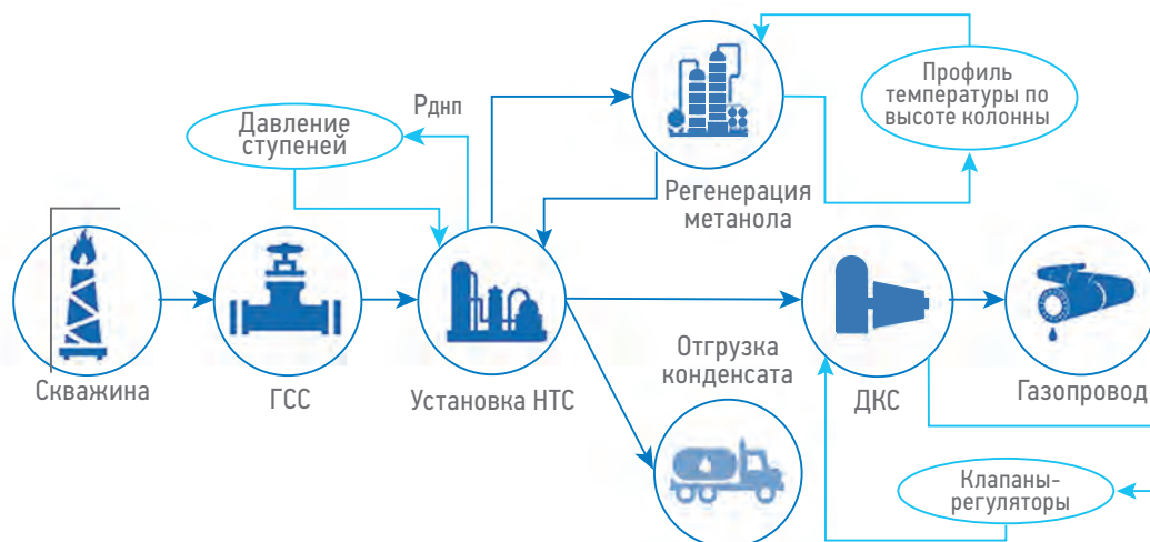
Рис. 1. Принципиальная схема газодобывающего актива. Составлено автором Fig. 1. Gas producing asset conceptual diagram. Designed by the author
