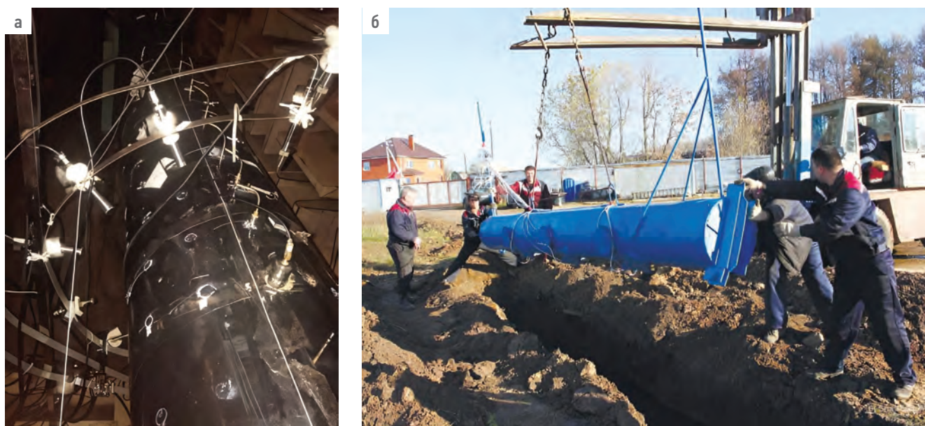
Рис. 4. Полевые стенды тестирования оптоволоконных систем обнаружения утечек [8], [9]
