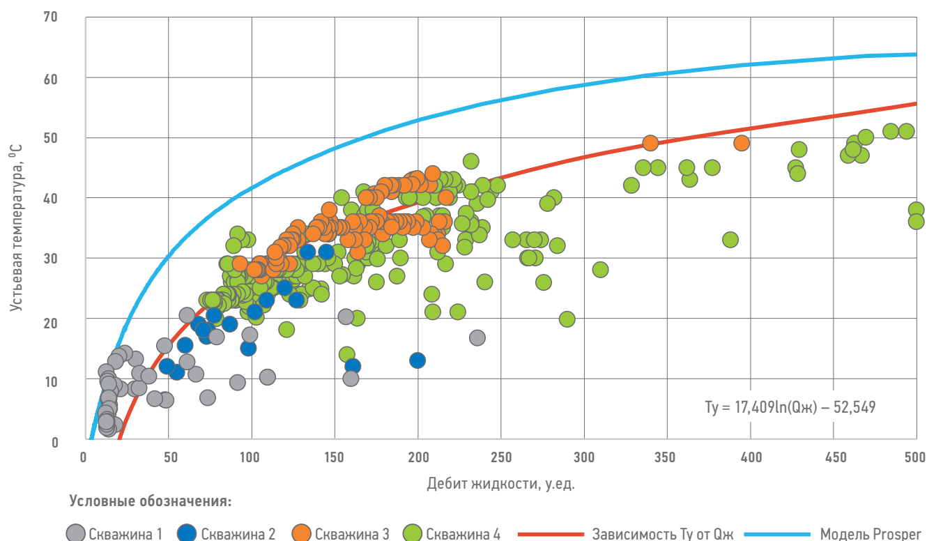
Рис. 2. Зависимость температуры от дебита жидкости. Составлено авторами Fig. 2. Temperature-liquid rate relationship. Prepared by the authors
