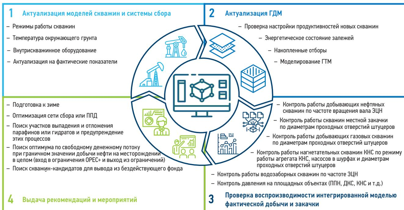
Рис. 2. Цикл мониторинга разработки актива с использованием ИМ. Составлено авторами
