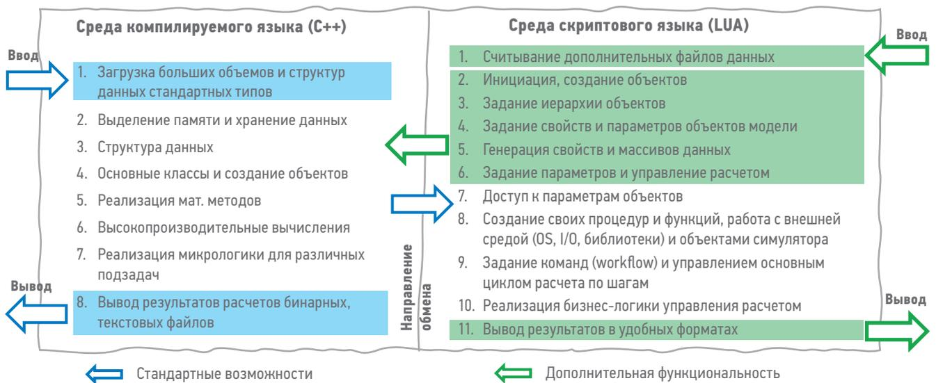
Рис. 2. Функциональный состав ядра симулятора и функциональное дополнение от использования скриптового языка. Составлено автором
