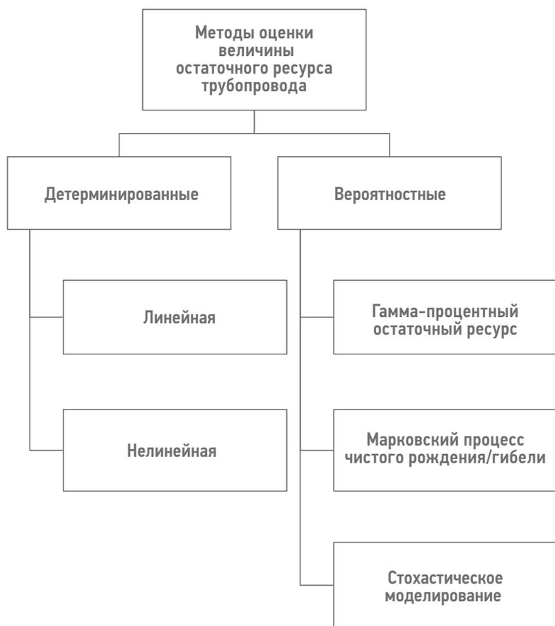
**Рис. 1.** Классификация методов оценки остаточного ресурса трубопровода.
