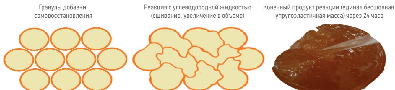
**Рис. 2.** Механизм и стадии реакции добавки самовосстановления с углеводородной жидкостью. Составлено авторами
