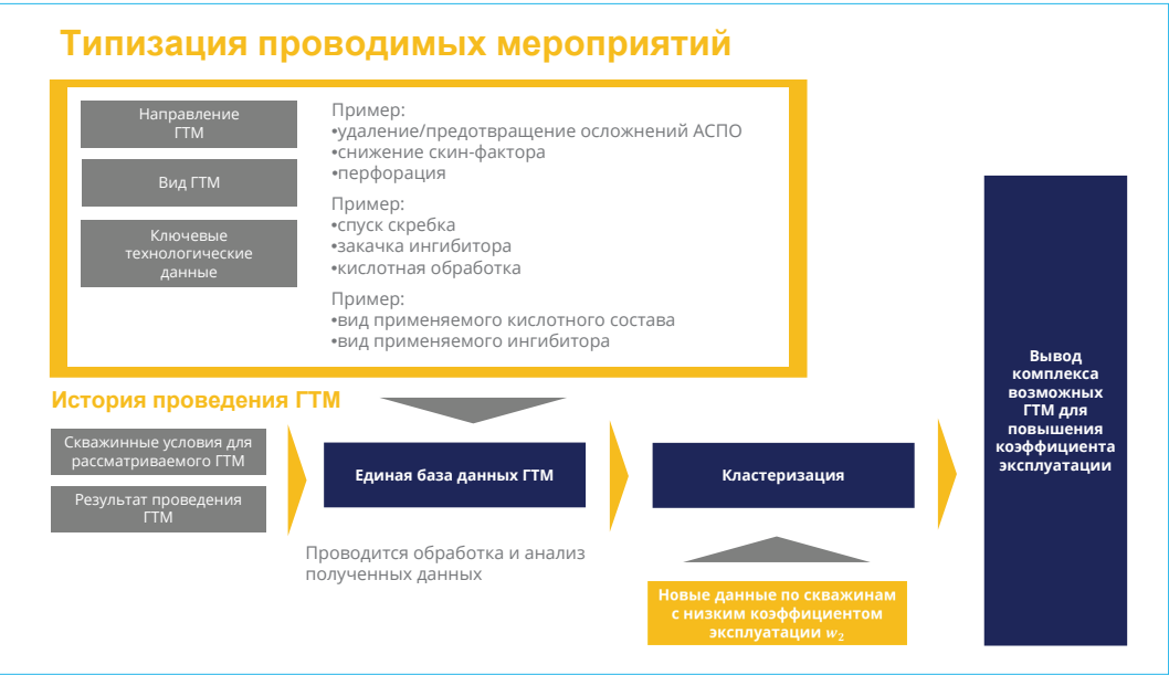
Рис. 2. Структурная схема системы подбора решений для улучшения функции эксплуатации скважин. Составлено авторами
