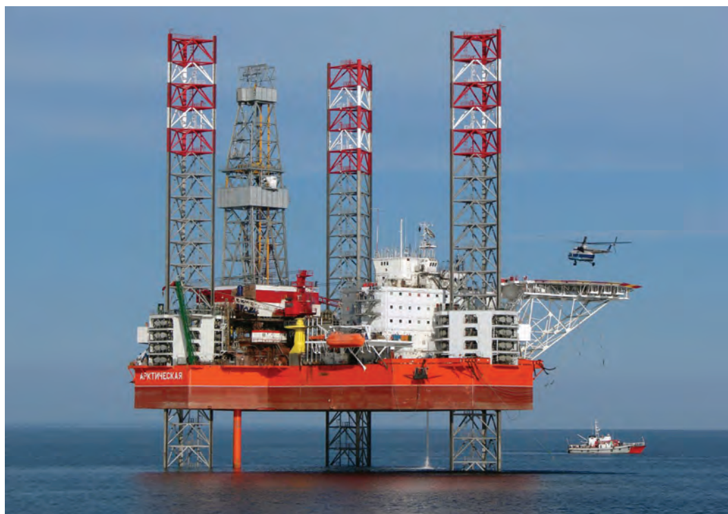
Рис. 1. Самоподъёмная плавучая буровая установка («Арктическая»). Составлено авторами Fig. 1. Jack-up drilling rig (Arctic). Figure prepared by the authors
