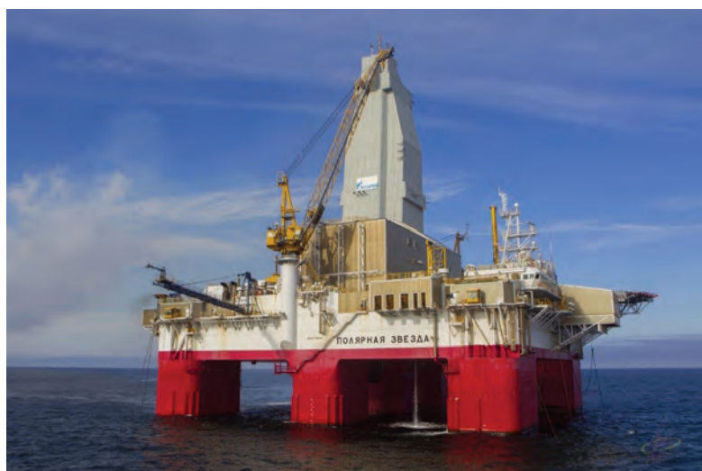
Рис. 2. Полупогружная плавучая буровая установка («Полярная звезда»). Составлено авторами Fig. 2. Semisubmersible drilling rig (Polar Star). Figure prepared by the authors
