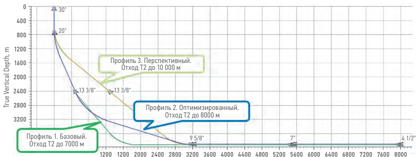
Рис. 4. Варианты профилей скважин. Составлено авторами Fig. 4. Well profile options. Figure prepared by the authors
