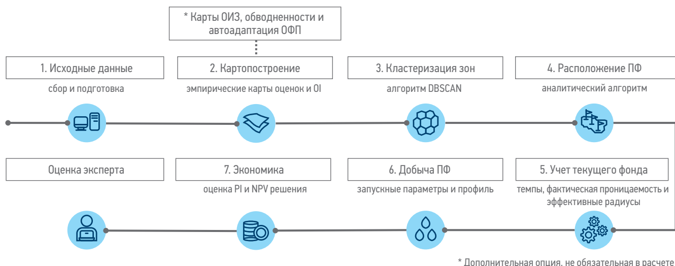
Рис. 1. Блок-схема модуля «АВНС». Составлено авторами Fig. 1. Block diagram of the "AVNS" module. Prepared by the authors
