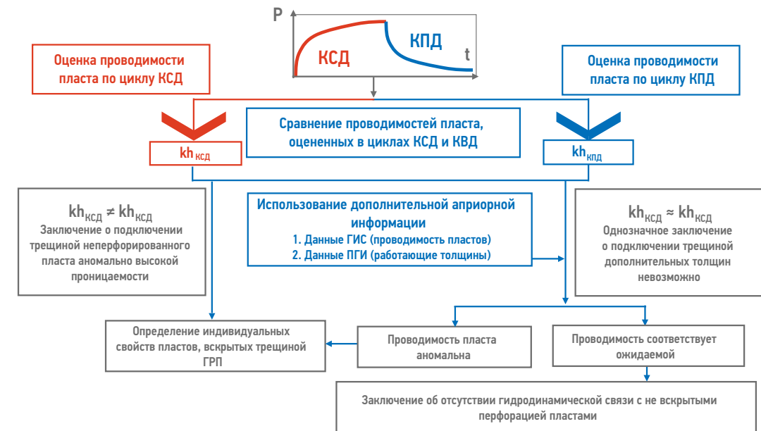
Рис. 3. Алгоритм совместной интерпретации гидродинамических и промыслово-геофизических исследований для оценки дополнительных толщин коллекторов, подключаемых к закачке нестабильной трещиной авто-ГРП. КСД — цикл стабилизации давления, КПД — цикл падения давления. Составлено авторами Fig. 3. Algorithm for the complex interpretation of well testing and production logging studies to assess additional thicknesses of reservoirs connected to the injection of an unstable spontaneous hydraulic fracturing. KSD — pressure of draw-down test, KPD — pressure of fall of test. Made by the authors
