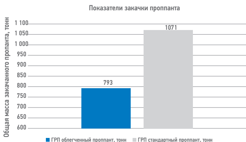
Рис. 4. Сравнительные данные по массе закачанного проппанта для скважин с опытными работами и окружением со стандартными операциями.
