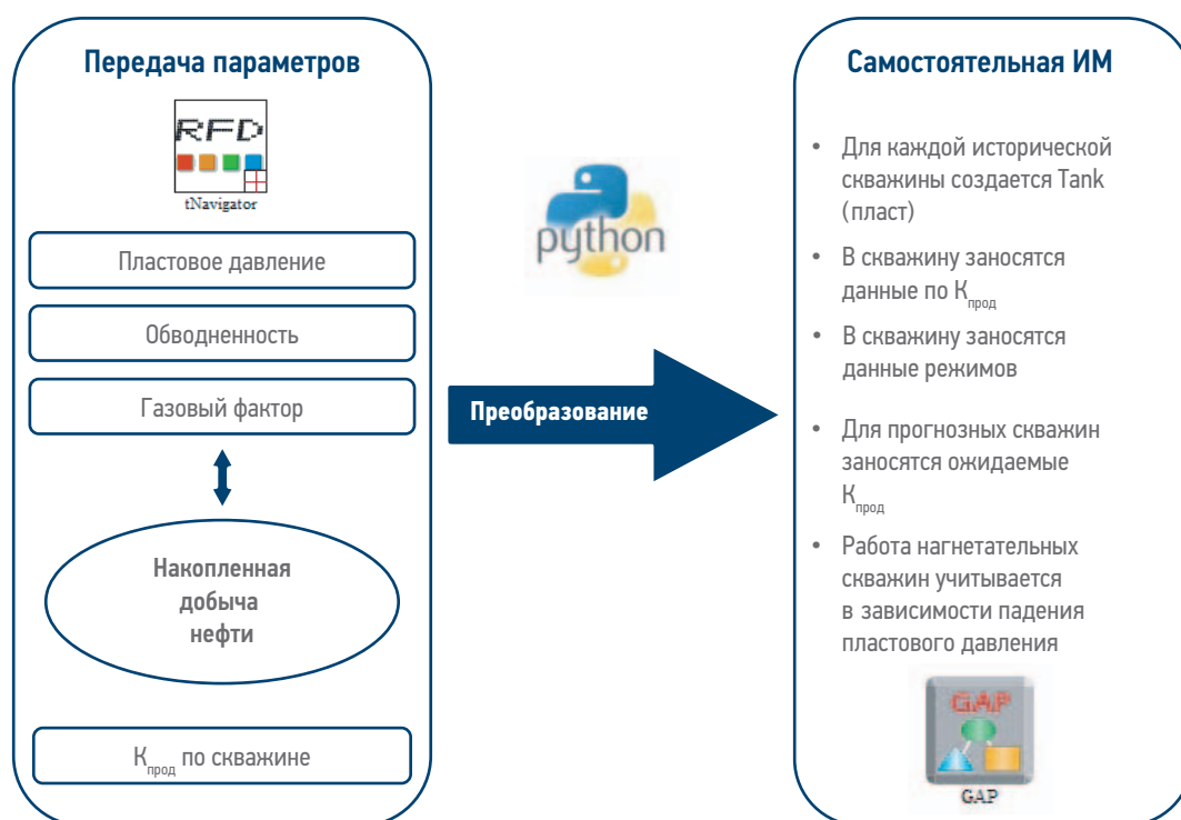
Рис. 2. Принцип работы модуля преобразования в Proxy-модель. Составил Ходаков И.О. Fig. 2. The principle of operation of the module for converting to a proxy model. Prepared by Khodakov I.O.
