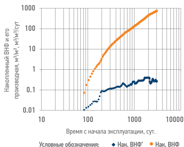
Рис. 5. Диагностические графики в билогарифмических координатах по скважине №13G [15]
