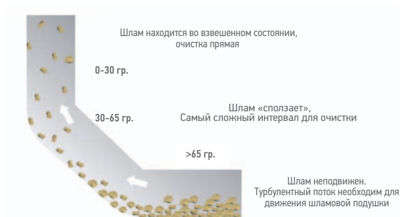
Рис. 2. Вынос шлама при различных углах наклона ствола скважины. Составлено авторами Fig. 2. Removal of cave-in mud at different deviations of the well. Made by the authors
