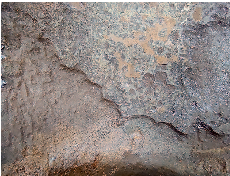
Рис. 2. Фото сегмента газопровода после первой ступени компримирования, очищенного от отложений. Фото авторов
